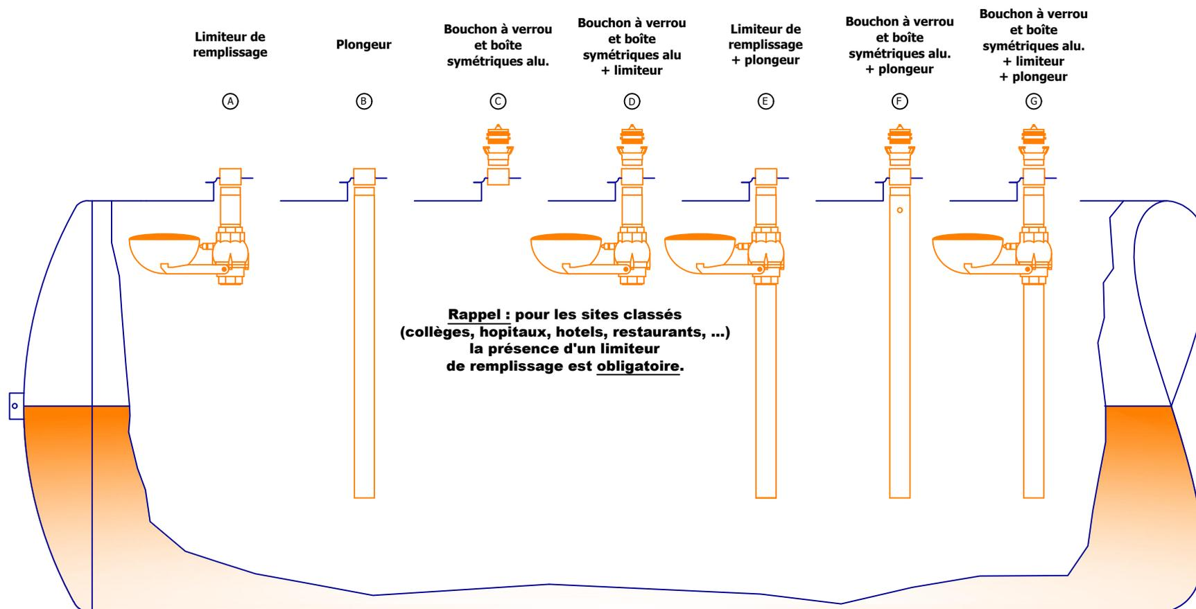
Nos offres de "remplissage" vous permettent de répondre aux différentes obligations des installations (particulier, site classé). Les plongeurs évitent la formation de mousse lors du dépotage, pouvant créer des débordements.
