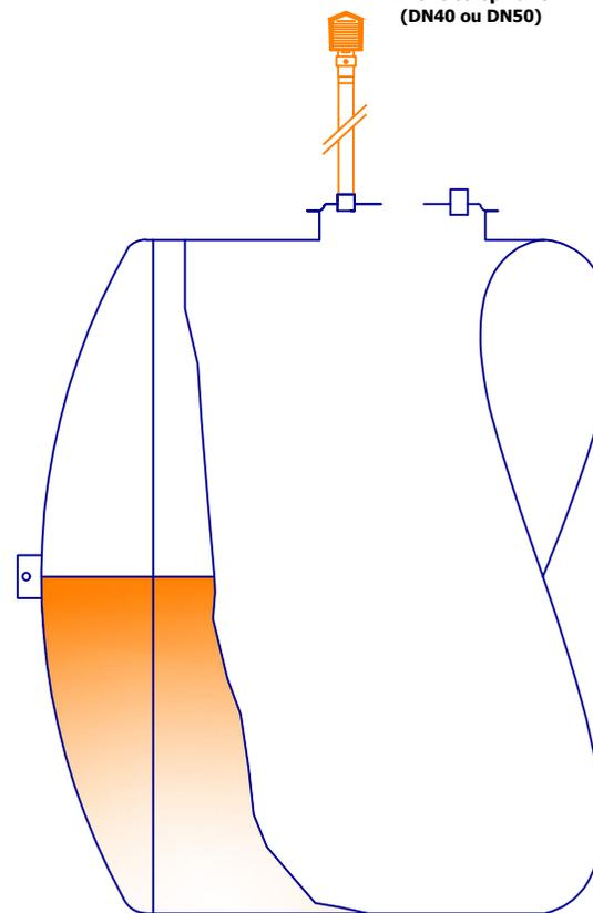
Nous pouvons vous fournir les événements. Le diamètre est fonction du débit des pompes en remplissage et / ou vidange. L'évent doit être installé hors sol pour les réservoirs enterrés)
